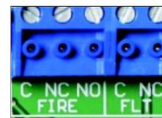
**Relé FLT** - Fornece um sinal de avaria normalmente fechado a dispositivos externos. Rating do relé de contacto: 30V DC / 2A. máximo resistivo. Também ativo para avaria no microprocessador. Activo até ser reiniciado e todas as avarias serem limpas. O relé de contacto irá abrir-se quando a falta estiver presente no sistema.
