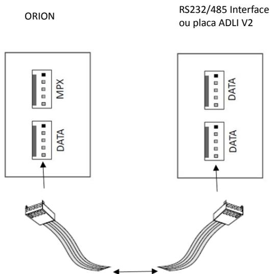
Cabo flat de 5-vias desde o conector DATA de 5-vias na parte de baixo da PCB ORION ao conector DATA de 5-vias no RS232/485 ou placa ADLI V2
